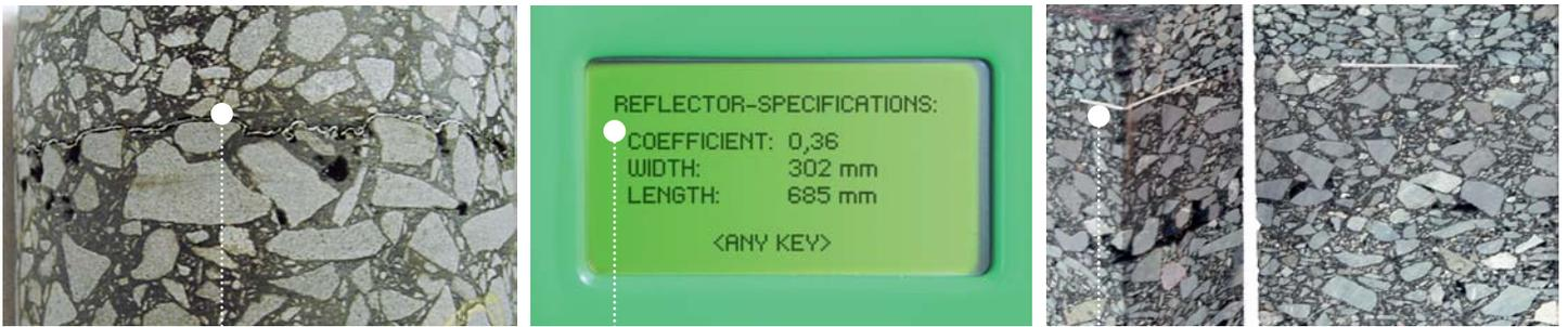
コアサンプルを使用する測定に比べて、シートを使用する測定方法は、舗装厚が正しく測定できない恐れがあります。
