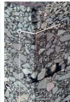
MIT圆形反射器AL RO 07在铣削表面上不会变形。通过使用MIT-SCAN-T2搜索模式，可以精确确定取芯位置。
