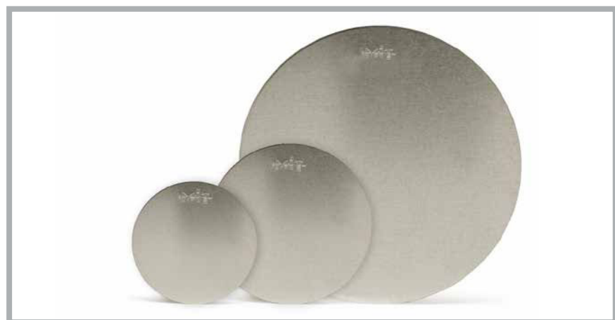
Abbildung 2: Beispiel Aluminium-Ronden für das Messen der Deckschicht (klein), der Binderschicht (mittlere Größe) bzw. der Tragschicht (groß)
