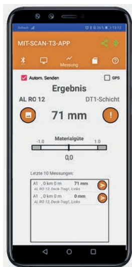
So wird die Schichtdickenmessung in der MIT-Scan-T3-App angezeigt
