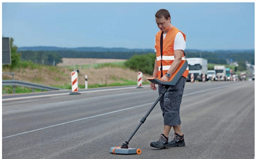
Das MIT-Scan-T3 im Einsatz auf der Baustelle
