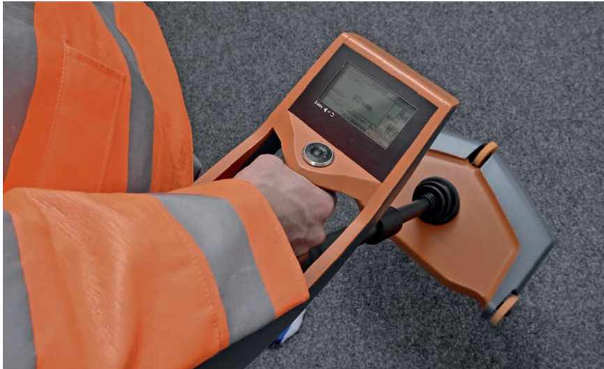
Die Anzeige der Schichtdickenmessung auf dem MIT-Scan-T3
