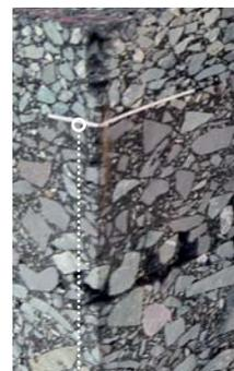
Die MIT-Ronde AL RO 07 wird auf einer gefrästen Fläche nicht deformiert. Der Bohrkern konnte durch den Suchmodus des MIT-SCAN-T2 sehr gut zentriert werden.
